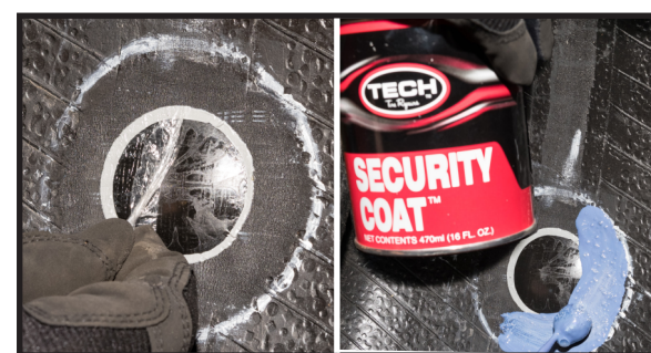
10. Usuń z kapelusza przezroczystą folię zabezpieczającą. W oponach bezdętkowych pokryj szlifowaną gumę i obrzeże kapelusza uszczelniaczem butylowym (Security Coat #738 lub Butyl Liner Repair Solution #739). W oponach dętkowych naprawę pokryj takim technicznym.
