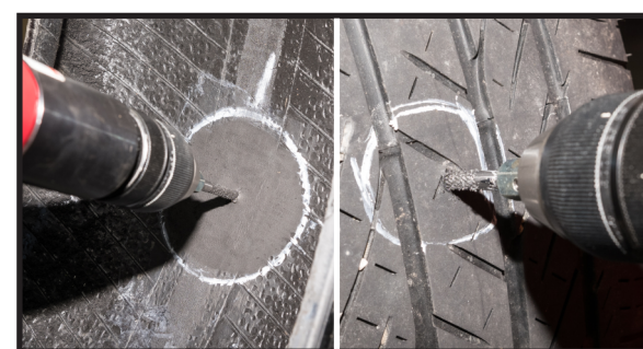
4. Skalibruj kanał uszkodzenia odpowiednim frezem z prędkością 1200 obr./min. Czynność tą wykonaj najpierw od środka opony (5-8 razy), następnie powtórz ją od zewnątrz. Wszystkie uszkodzone i luźne kordy opasania i osnowy muszą zostać usunięte.
