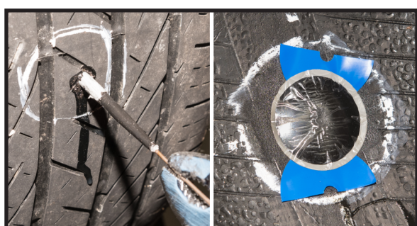
8. Posługując się szczypcami przeciągnij kolek do momentu, aż będzie dociśnięty do opony (pośrodku kapelusza pojawi się niewielkie wgłębienie).
