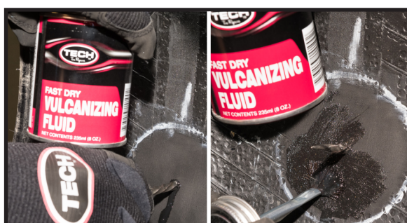
6. Wprowadź płyn wulkanizacyjny (Fast Dry Vulcanizing Fluid #760 lub Heavy Duty Blue Vulcanizing Fluid #775) w kanał uszkodzenia posługując się szpikulcem spiralnym. Szlifowaną gumę pokryj cienką warstwą płynu wulkanizacyjnego. Pozostaw płyn do wyschnięcia do momentu osiągnięcia lepkości kontaktowej (3-5 min dla płynu #760, 5-8 minut dla płynu #775.).
