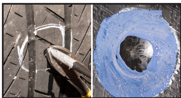
11. Utnij kolek 2-3 mm powyżej opony nie ciągnąc za niego. Opona jest gotowa do montażu i użytkowania.
