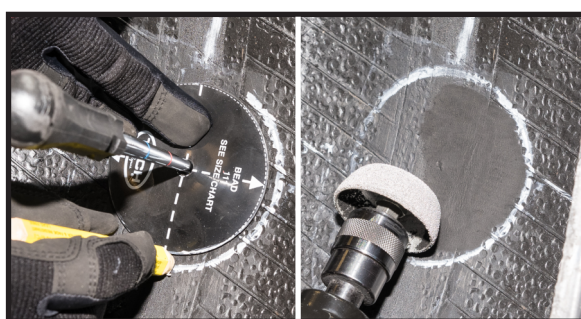
3. Odrysuj wewnątrz opony centralnie względem przebicia obszar większy o 10 mm niż kapelusz kołka. Następnie wyszlifuj zaznaczony obszar odpowiednią ściernicą. Maksymalna prędkość szlifowania gumy wynosi 4500 obr./min.
